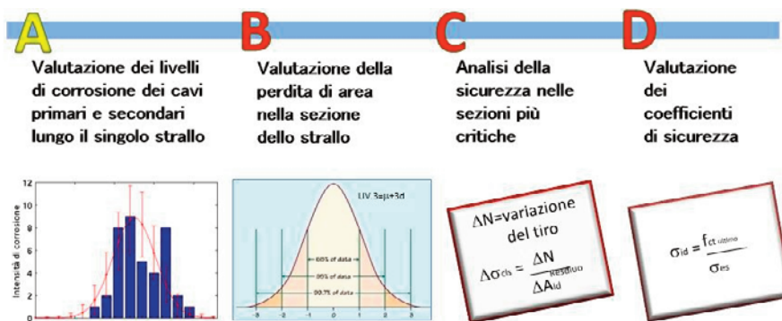
Figura 8. Metodo di valutazione della sicurezza degli stralli a seguito di indagine riflettometrica.
